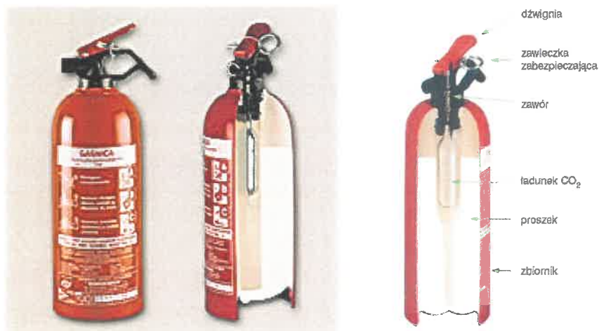
1 – dźwignia, 2 – zawleczka zabezpieczająca, 3 – zawór, 4 – ładunek CO 2 (dwutlenek węgla), 5 – proszek gaśniczy, 6 – zbiornik.
