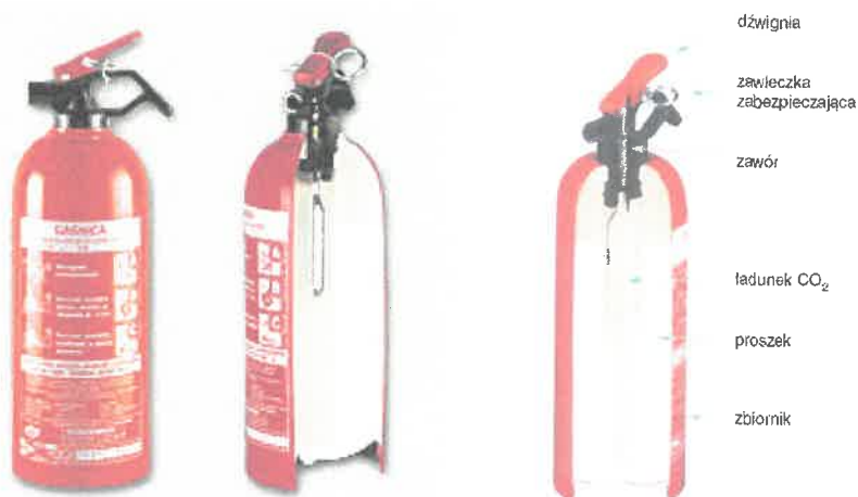
1 – dźwignia, 2 – zawleczka zabezpieczająca, 3 – zawór, 4 – ładunek CO 2 (dwutlenek węgla), 5 – proszek gaśniczy, 6 – zbiornik.
